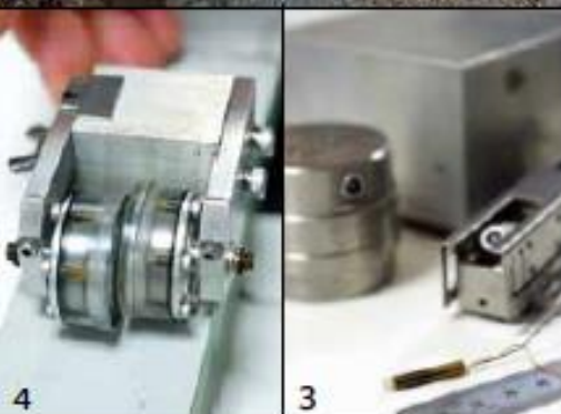
1. 水の揺れを超音波を用いて読み取るセンサーの仕組みについて話す澤山社長 2. 敷地内に試験用の電柱を埋め、地下にある電柱の破損を調べる実験のようす 3. 世界最大と最少のプロープなど 4. コンクリート表面などの亀裂を検知するプロープ(検査器具)
